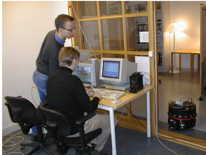
Figur 4. Kontrollrummet från vilket roboten styrs under Wizard-of-Oz-testet. För att hantera roboten under testen krävdes två personer, en som styrde roboten och en som hanterade talsyntessystemet.
