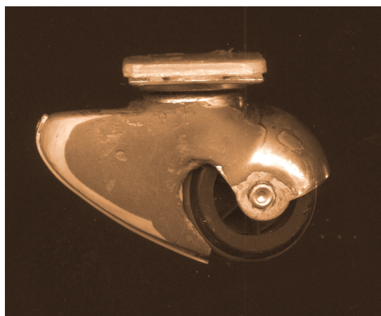
Figur 10. Förslag på utformning av stödhjul., med en bakre glidskena, för att kunna ta sig nerför trösklar.
