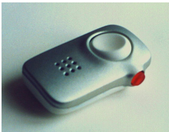
Figur 7. "Walkie-talkie"-liknande fjärrkontroll till roboten. Nödknapp och tumstyrd joystick används för att detaljstyra roboten. Övrig kontroll sker genom talad input (mikrofon).
