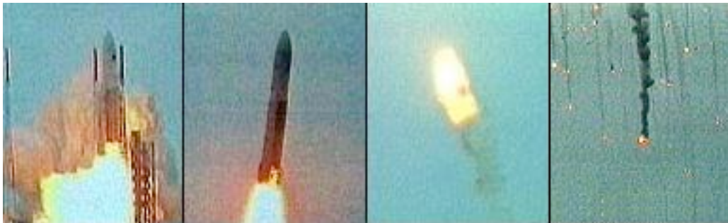
Så kan det gå när det är fel i programmet. Den europeiska Ariane 5-raketen havererar 40 sekunder efter uppskjutningen i juni 1996.
